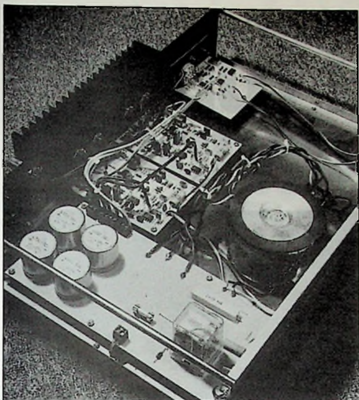
Foto 2. De 60-120 van binnen gezien. Een zware ringkern- trafo plus 2 \times 2 grote elco's verzorgen de voeding. Beide eindtrappen zijn gescheiden uitgevoerd. De robuuste versterker is perfect gebouwd en er zijn duidelijk kwaliteitsonderdelen gebruikt.
